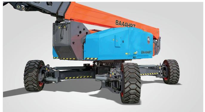
Nueva tecnología de expansión del eje in situ con una sola llave y protección de patente mundial.
